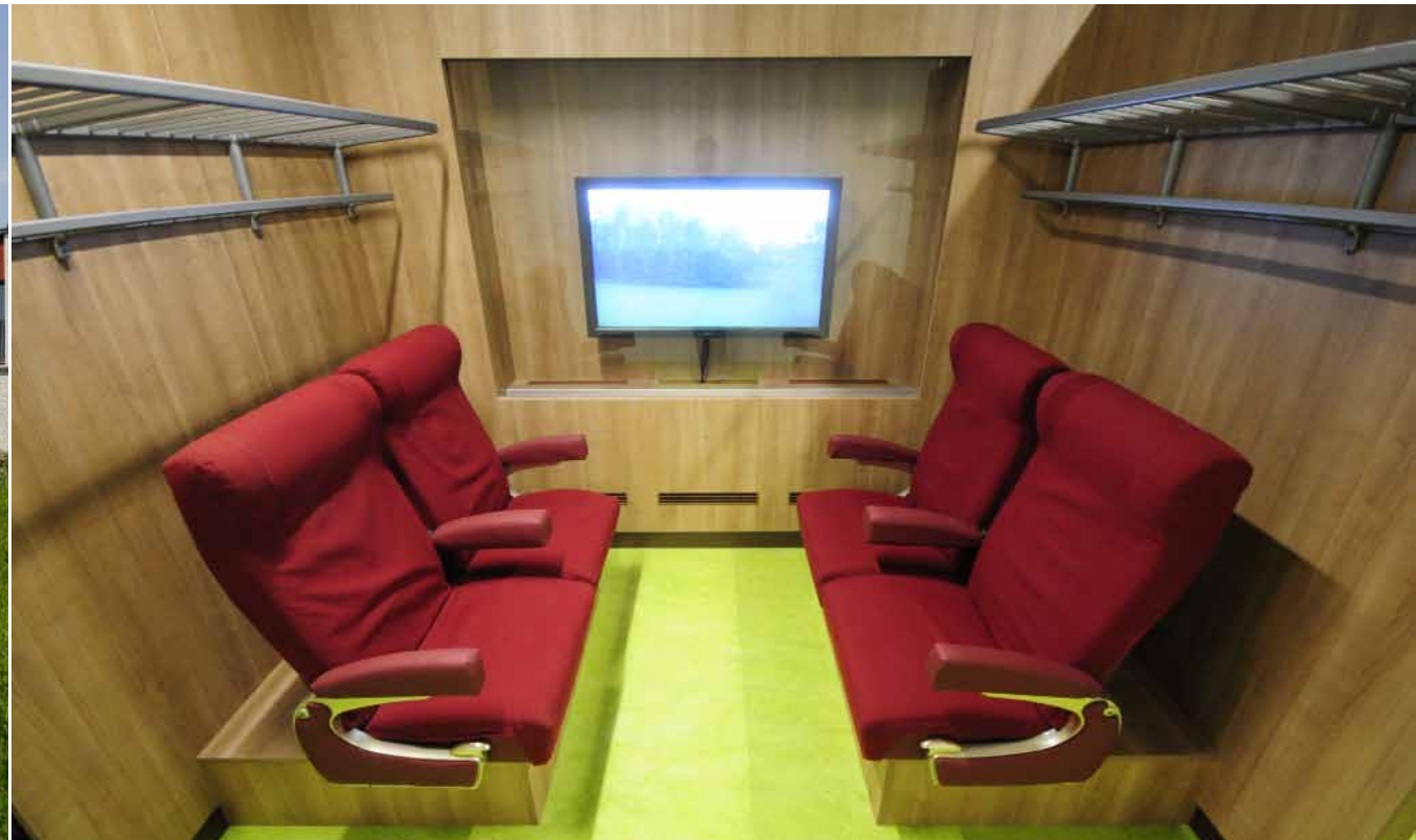
Virtuelles Zugabteil mit Surround Sound und 42" LCD Display, Wings Platinum Medienserver und Client-PC mit Touchscreen, Contenterstellung verschiedener Zugreisen für Therapie Zwecke
